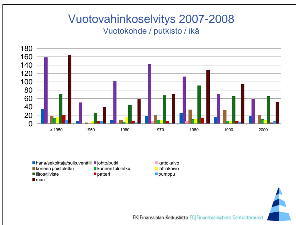
Kuva 47 Ikään suhteutettu putkistossa tapahtunut vuotovahinko
