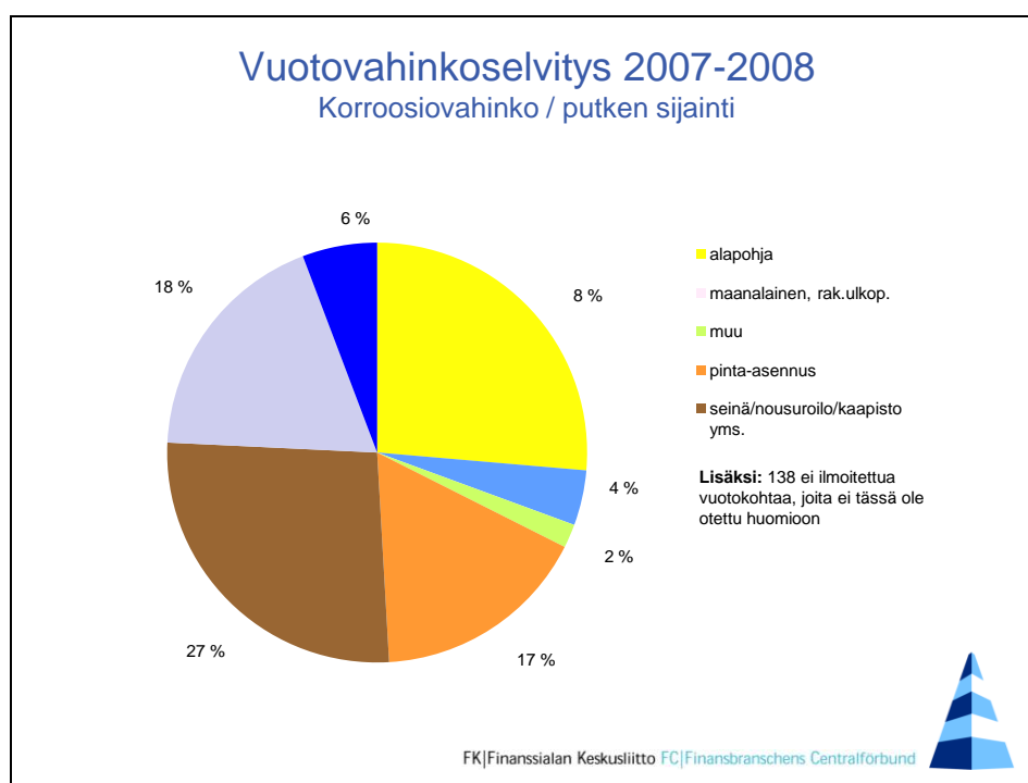
Kuva 40 Korroosion aiheuttamat vahingot kohteittain
