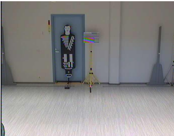
Kuva 6 Hylätty K 50. Kuvattu alue on liian leveä K50-kuvaksi tarkoitetussa ovipisteessä
